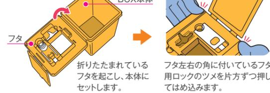
折りたたまれているフタを起こし、本体にセットします。フタ左右の角に付いているフタ用ロックのツメを片方ずつ押しはめ込みます。
